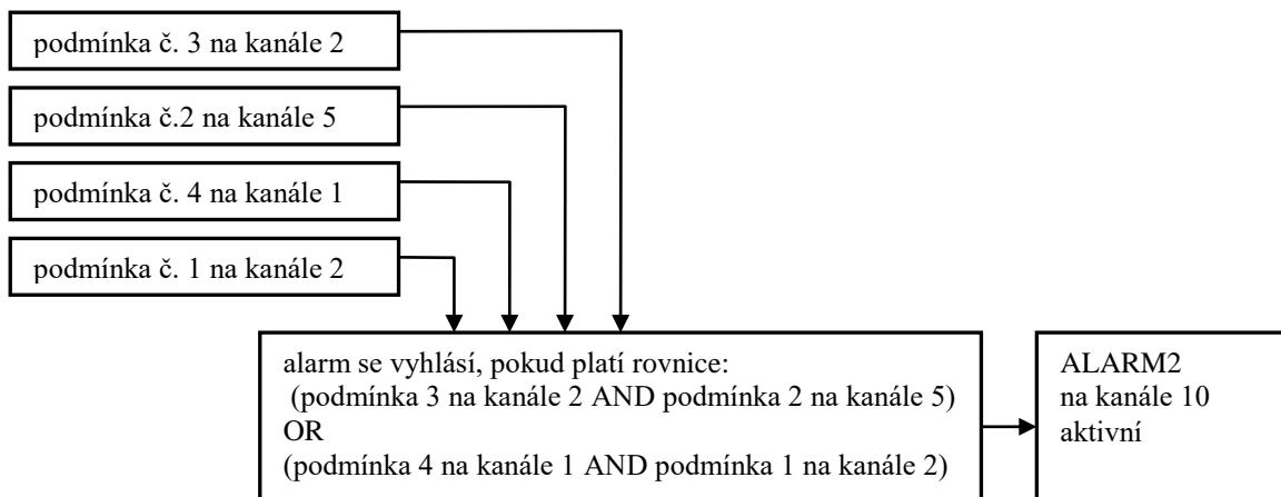
Alarm trvá, pokud jsou platné vstupní podmínky. Pomocí kombinací podmínek můžete řešit i složitější situace včetně dálkového řízení. Některé akce trvají po celou dobu alarmu (akustická signalizace, ALARM OUT aktivita, optická signalizace, sepnutí relé), jiné pouze v okamžiku vzniku alarmu (SMS zprávy, e-mailsy). Změny na výstupu ALARM OUT i změny alarmů je možné zaznamenávat.
