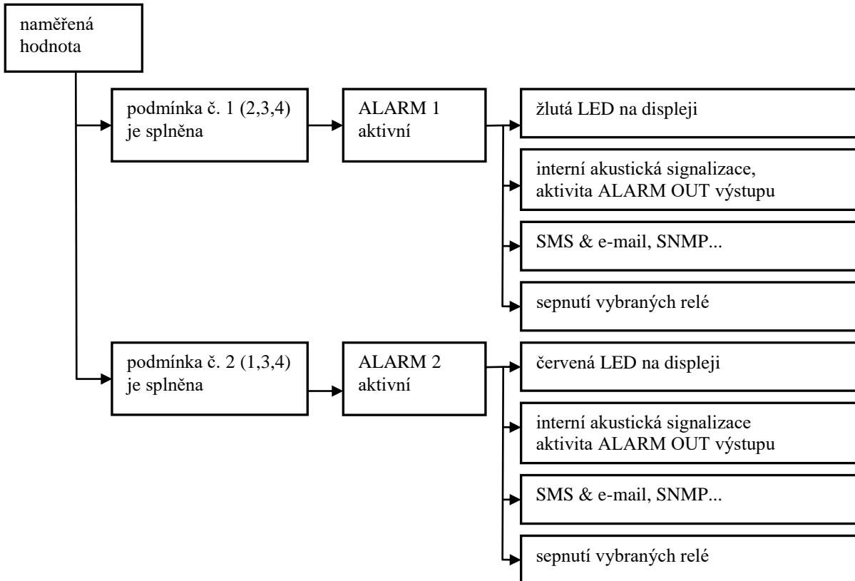
Příklad vzniku alarmu při použití logické kombinace podmínek:
